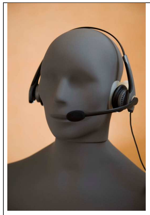
Figure 2 : simulateur de tête et torse (HATS) équipé d'un casque téléphonique (en blanc, oreille gauche du HATS équipée d'un simulateur d'oreille occluse).
